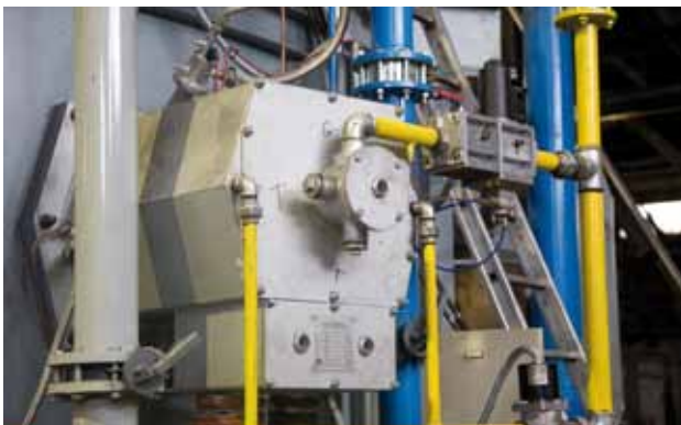
REGFIRE®-Brenner an einem Drehherdofen zum Schmieden von Ringen
